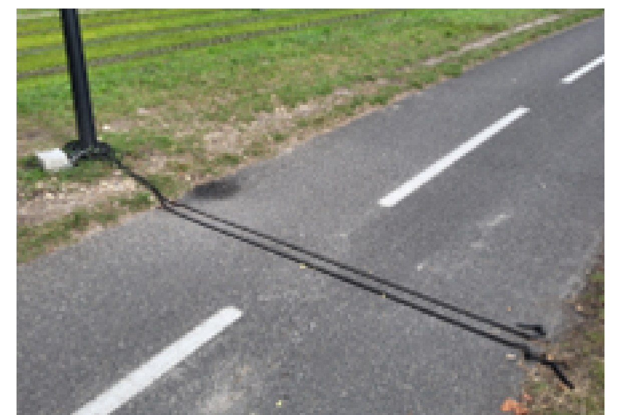
Tubes pneumatiques pour déterminer le trafic 2 roues.
